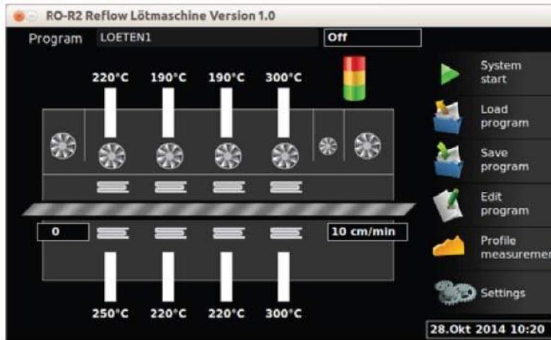
Reflow "Heating Off"를 한 상태에서 Chamber가 50°C 이하 일 때. Main power를 OFF 하세요.
